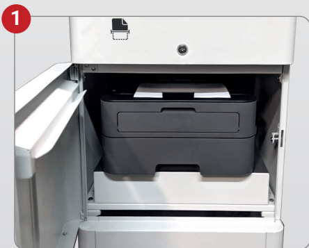
1. Impresora A4 con dos bandejas de entrada para 550 hojas, integrada al equipo.
