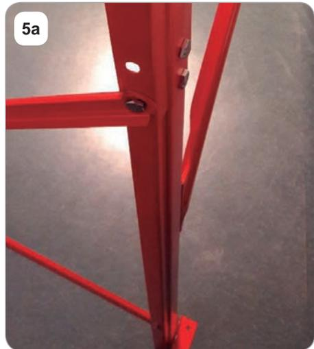
Tal como se muestra en la figura "5a", un extremo de la cruz irá en la parte interna de la pata y el otro extremo en la parte externa. (Esto sucede en ambas estructuras).
