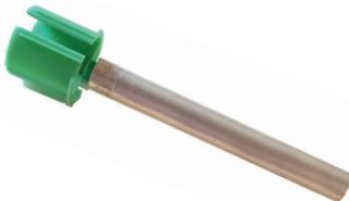
Es una barra de magnesio que va dentro de las calderas o tanques donde se calienta agua y cumple la función de evitar la corrosión del tanque, alargando su vida útil. También es llamada barra de sacrificio, dado que tiene más afinidad a corroerse que el acero.
