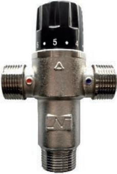
Esta válvula se encarga de realizar una mezcla entre el agua caliente proveniente del Termotanque y el agua fría. Esto se hace para regular la temperatura del agua que desea obtener el usuario y eventualmente prevenir quemaduras. La válvula mezcladora es un opcional.
